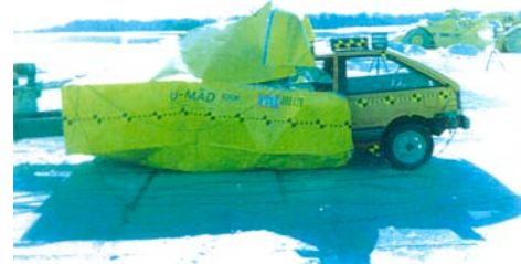
TMA puden efter at være blevet af personbil med over 100 km/t
