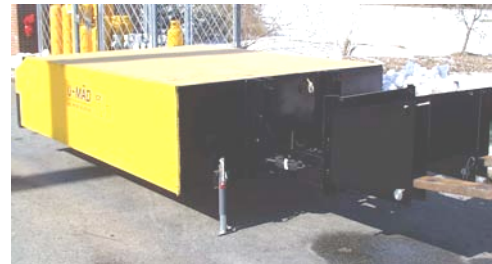
U-MAD Stødpude med standard monteringsbrakette, hydraulikstation og krankonsol (passer til HMF kranbeslag på lastbil)
